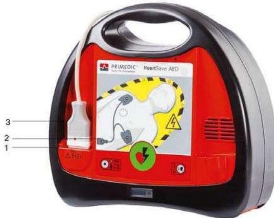
**Abb. 18: Elektrodenstecker einstecken**
